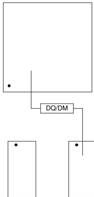
Figure 2-12. DQ/DM Routing to Two DDR4 SDRAM Devices
