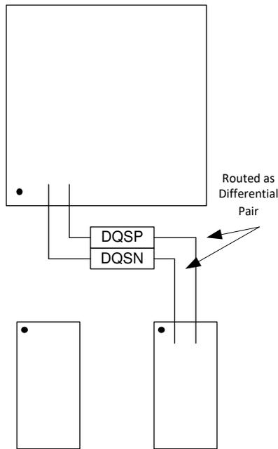
Figure 2-11. DQS Routing to Two DDR4 SDRAM Devices
