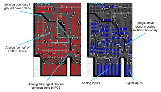
Figure 4-9. Analog/Digital Isolation
