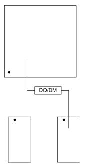
Figure 2-12. DQ/DM Routing to Two DDR4 SDRAM Devices
