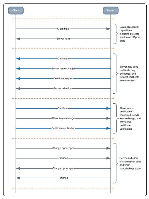
Figure 2-2. SSL/TLS Handshake
