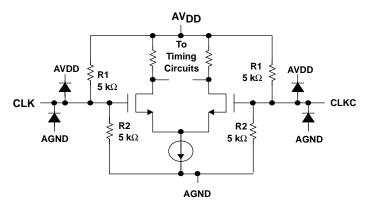
Figure 20. Clock Inputs
