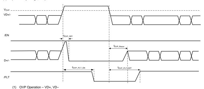
Figure 1. TPD2S701-Q1 Timing Diagram
