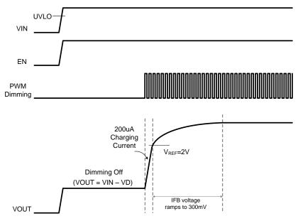
Figure 17. Soft-Start Waveforms
