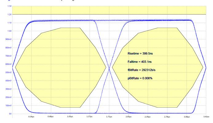
Figure 28. Transmit Eye Diagram (BMC)
