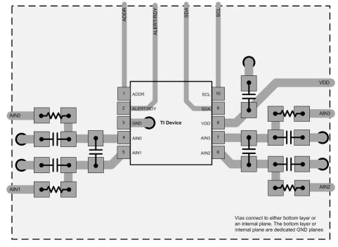
Figure 9-13. ADS1015L VSSOP Package
