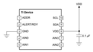
Figure 9-11. ADS1015L Power-Supply Decoupling
