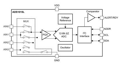
Figure 7-2. ADS1015L Block Diagram
