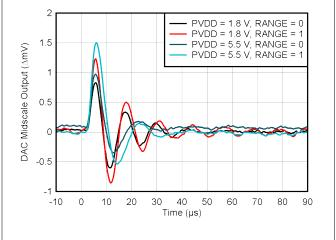
Figure 6-26. DAC Glitch Impulse Falling Edge
