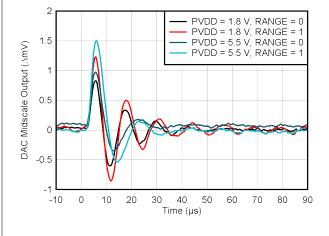
Figure 6-26. DAC Glitch Impulse Falling Edge
