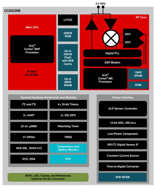
Figure 4-1. CC2652RB Block Diagram
