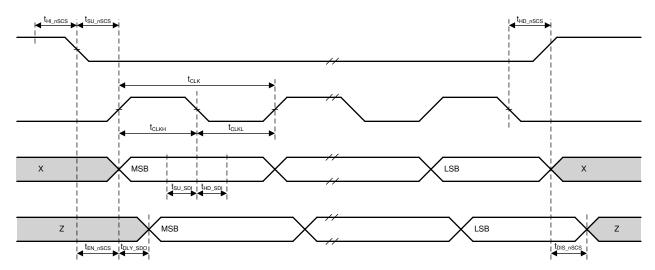
Figure 1. SPI Slave-Mode Timing Diagram
