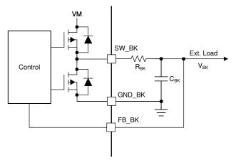
Figure 8-9. Buck (Resistor Mode)
