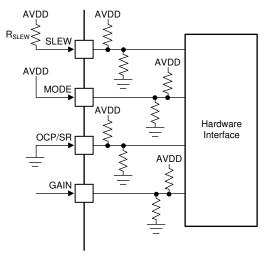
Figure 8-7. DRV8316T-Q1 Hardware Interface
