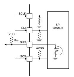
Figure 8-6. DRV8316R-Q1 SPI Interface
