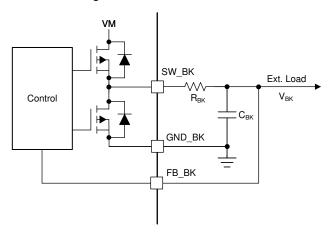
Figure 8-9. Buck (Resistor Mode)
