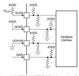
Figure 8-8. DRV8316CT-Q1 Hardware Interface
