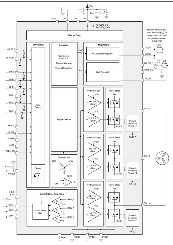
Figure 8-2. DRV8316CT-Q1 Block Diagram
