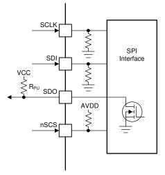
Figure 8-7. DRV8316CR-Q1 SPI Interface
