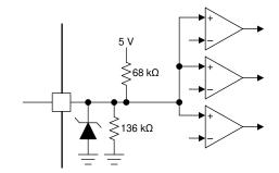
Figure 7-9. Quad-Level Input
