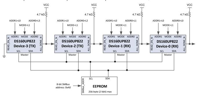
Figure 7-2. Daisy Chain Four DS160UP822 Devices to Read from Single EEPROM
