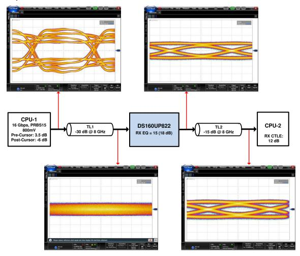
Figure 8-3. UPI 2.0 Link Reach Extension Using DS160UP822
