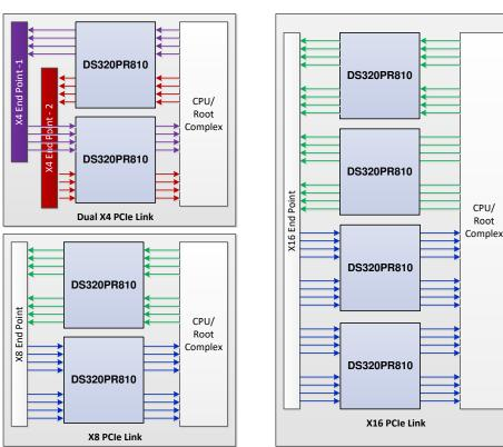
Figure 8-1. PCI Express x4, x8 and x16 Use Cases Using DS320PR 810
