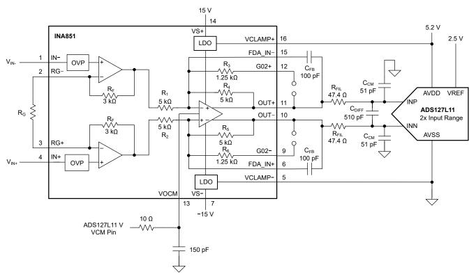
Figure 9-9. Driving the Delta-Sigma ADC ADS127L11
