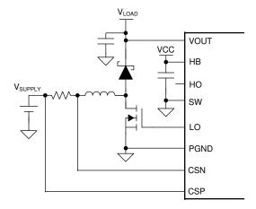
Figure 10-9. Non-Synchronous Boost Configuration
