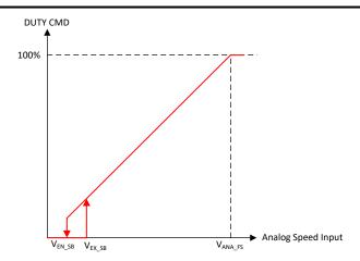
Figure 7-8. Analog-Mode Speed Control
