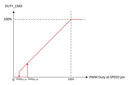
Figure 7-9. PWM-Mode Motor Control
