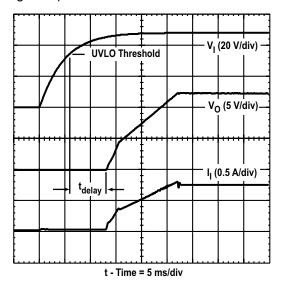
Figure 13. Soft-Start Waveform
