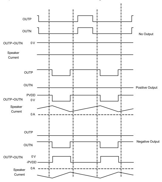
Figure 6-9. 1SPW Mode Modulation
