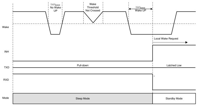
Figure 9-6. Local Wake-Up - Falling Edge
