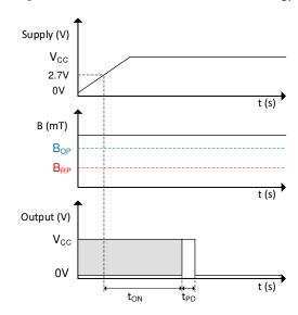
Figure 8-6. Power-On Time When B > B<sub>OP</sub>
