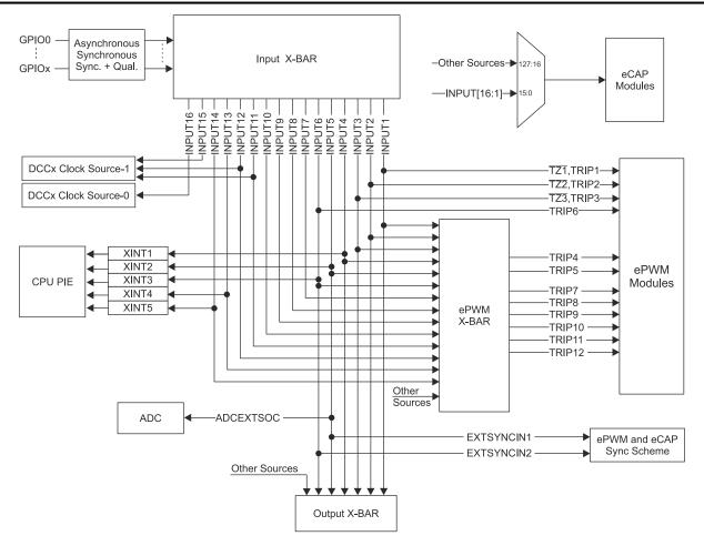
Figure 5-6. Input X-BAR
