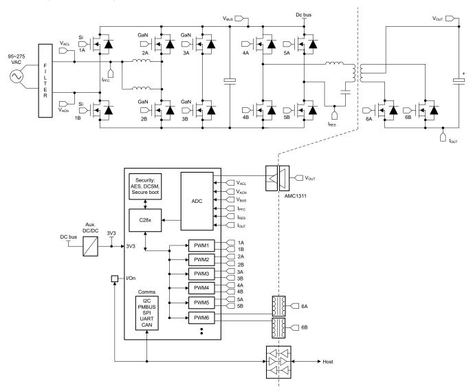
Figure 8-9. Merchant Telecom Rectifier Single-chip Architecture
