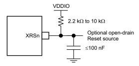
Figure 6-9. Reset Circuit
