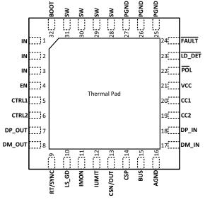
Figure 7-3. TPS25830QCWRHBRQ1 Package 32-Pin (VQFN) Top View <sup>(2)</sup>
