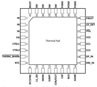
Figure 7-4. TPS25831QCWRHBRQ1 Package 32-Pin (VQFN) Top View <sup>(2)</sup>
