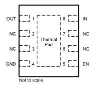
Figure 4-1. DRB Package, 8-Pin Fixed VSON (Top View)
