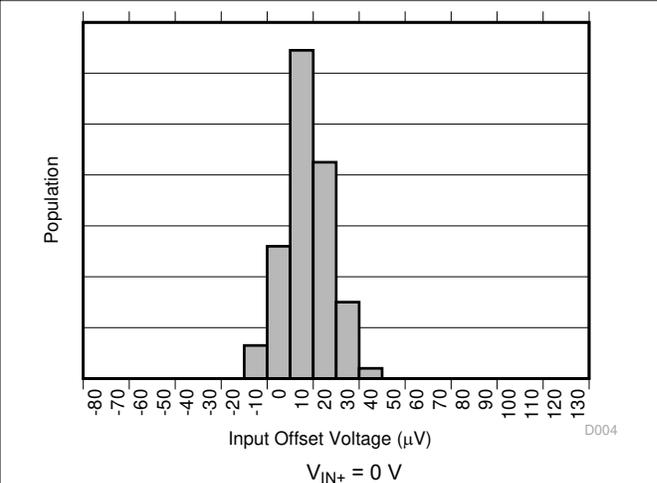
Figure 7-4. Input Offset Voltage Production Distribution A4
