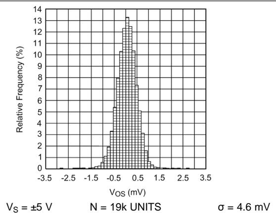
Figure 22.  $V_{OS}$  Distribution
