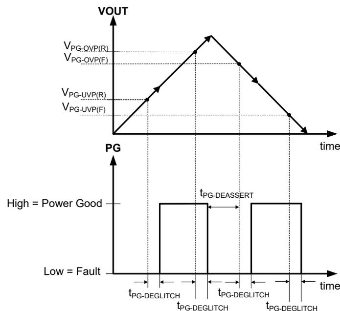
**Figure 7-6. Power-Good Thresholds**
