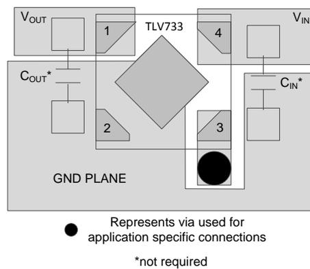
Figure 39. Layout Example for the DQN Package
