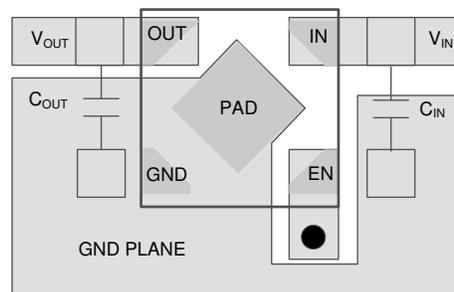
**Figure 7-8. Layout Example for the DQN Package**
