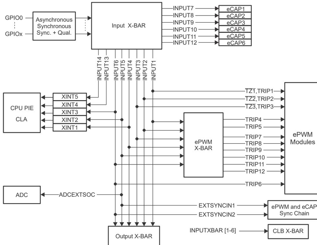
**Figure 5-7. Input X-BAR**
