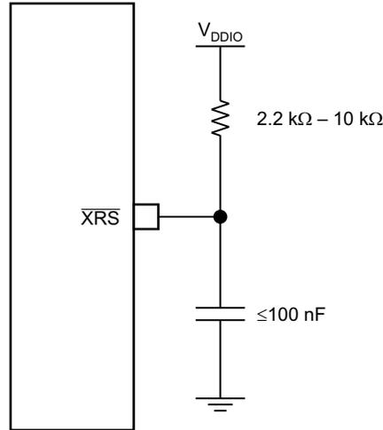
**Figure 6-4. Reset Circuit**
