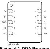
Figure 4-2. DQA Package, 10-Pin USON (Top View)
