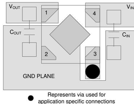
Figure 8-6. Layout Example for the DQN Package
