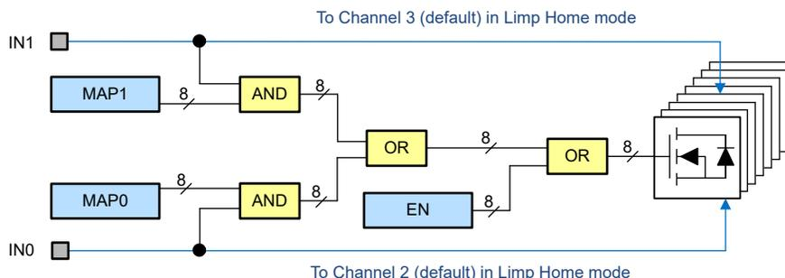
**Figure 7-2. Input Mapping**
