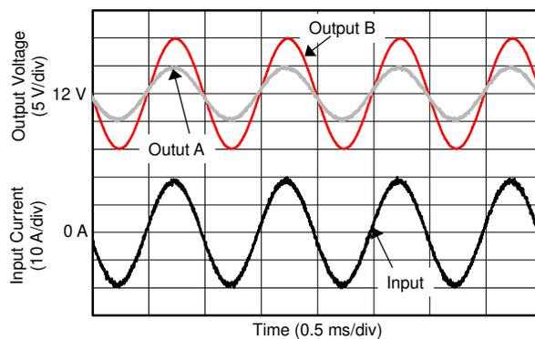
$V_S = 24\text{ V}$ ,  $V_{REF} = 12\text{ V}$
