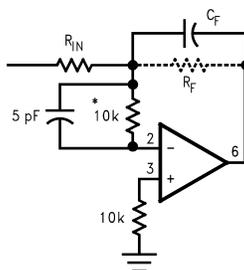
$C_F = \text{Large}$  ( $C_F \geq 50 \text{ pF}$ )
