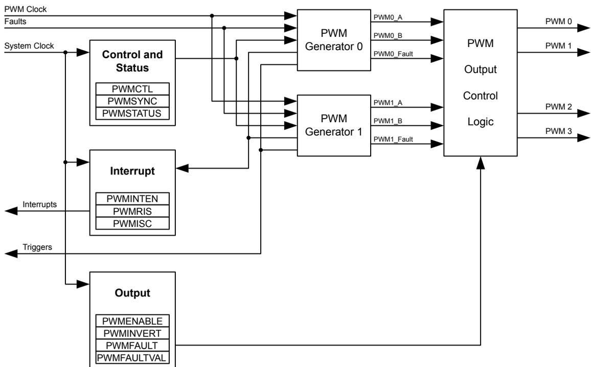
Figure 15-2. PWM Module Block Diagram
