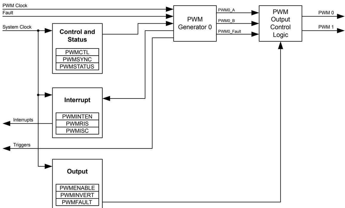
Figure 16-2. PWM Module Block Diagram
