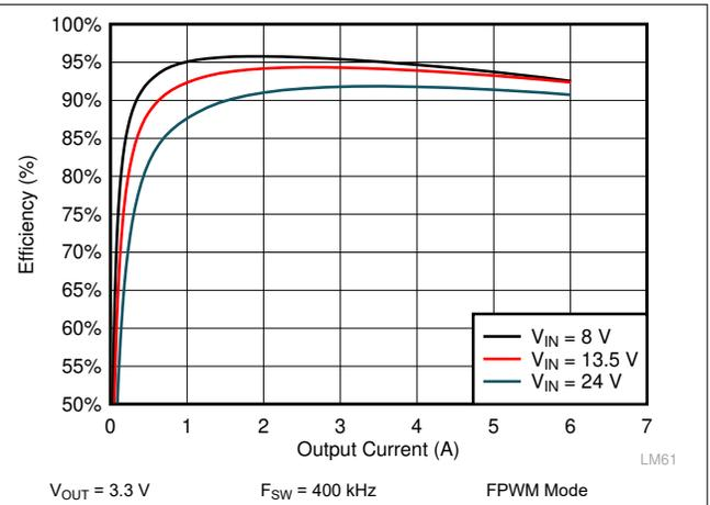
Figure 10-6. LM61460-Q1 Efficiency
