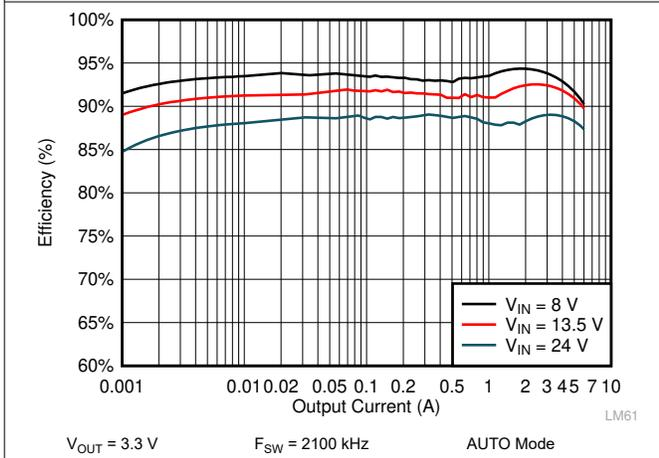
Figure 10-7. LM61460-Q1 Efficiency
