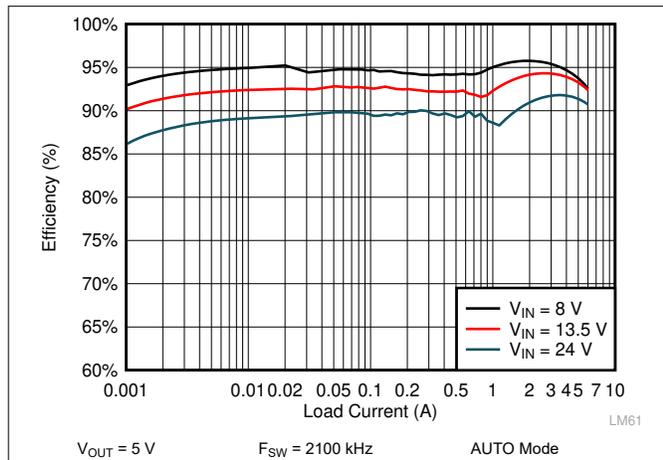
Figure 10-11. LM61460-Q1 Efficiency
