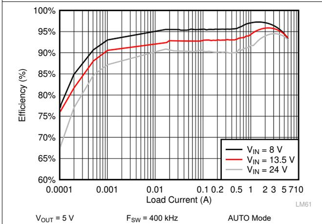
Figure 10-9. LM61460-Q1 Efficiency
