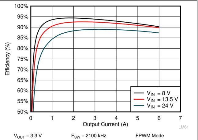
Figure 10-8. LM61460-Q1 Efficiency
