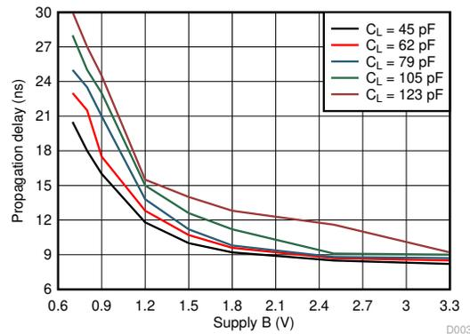
$T_A = 25^\circ\text{C}$   $V_{CCA} = 1.2\text{ V}$
