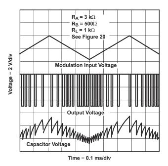
Figure 7-6. Pulse-Position-Modulation Waveforms
