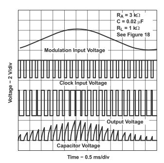
Figure 7-4. Pulse-Width-Modulation Waveforms
