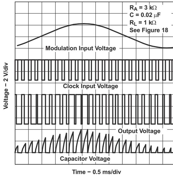
Figure 7-4. Pulse-Width-Modulation Waveforms
