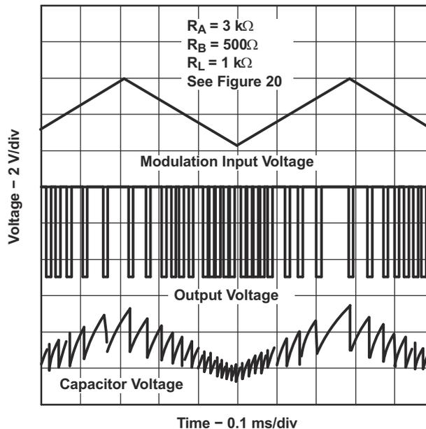
**Figure 7-6. Pulse-Position-Modulation Waveforms**
