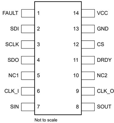
**Figure 5-1. TLC69699-Q1 DYY Package 14-pin SOT-23-THN Top View**
