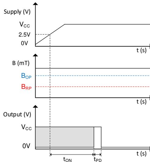
**Figure 8-6. Power-On Time When  $B > B_{OP}$**
