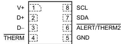
**Figure 5-1. DQF Package 8-Pin WSON Top View**
