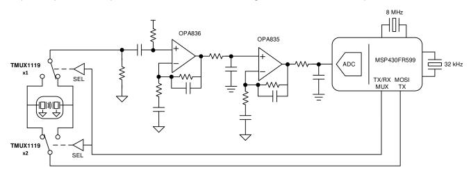
Figure 8-1. Ultrasonic Gas Meter System
